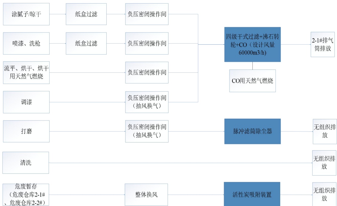
图 4-3 本项目废气处理流程图
