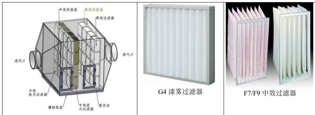
图 4-2 干式过滤器原理示意图
